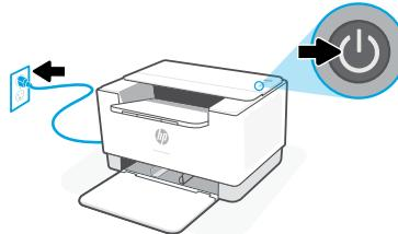
**NL** Verwijder alle tape en trek het vel papier uit de printer. Steek de stekker in het stopcontact en zet de printer aan.
