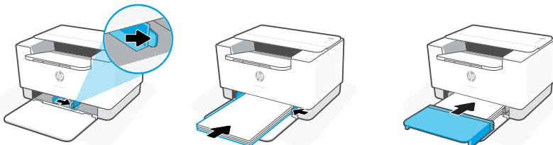
**CS** Vysuňte vodítka. Vložte papír formátu Letter nebo A4 a upravte vodítka. Zasuňte kryt zásobníku na místo.
