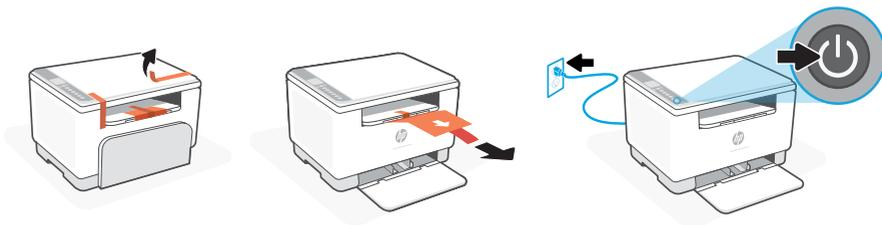
**NL** Verwijder alle tape en trek het vel papier uit de printer. Steek de stekker in het stopcontact en zet de printer aan.
