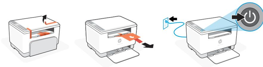
**SK** Odstráňte celú pásku a vytiahnite papierový hárok z tlačiarne. Zapojte tlačiareň do elektrickej siete a zapnite ju.
