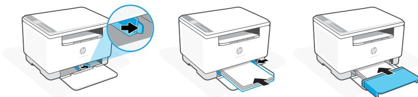
**CS** Vysuňte vodička. Vložte papír formátu Letter nebo A4 a upravte vodička. Zasuňte kryt zásobníku na místo.
